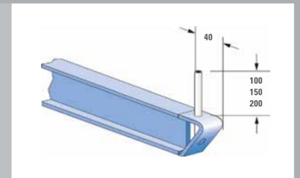
Abrollsicung Standard / Rohr verzinkt ø 16 mm
